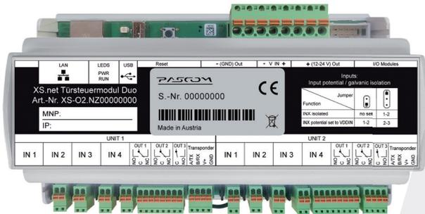
Das pascom XS.net Türsteuermodul Duo ist für die Ansteuerung von zwei getrennten Türen entwickelt worden und ist mit den Transponderlesern pascom XS.reader über die Schnittstelle RS232/RS485 verbunden. Das Modul ist für die Hutschienenmontage geeignet.
